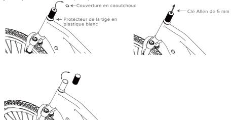
B. Placez la potence du guidon sur la tige avec l'écran vers le haut, replacez le capuchon supérieur et utilisez une clé Allen de 5 mm pour sécuriser la potence du guidon. Réinsérez le couvercle en caoutchouc dans le bouchon supérieur.
