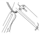
Paso 6. Instale la rueda delantera. Retire el inserto de plástico de la puntera de la horquilla.
