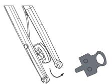
C. Instale con cuidado la rueda delantera y asegúrese de que el rotor del freno se asiente entre las pastillas de freno en la pinza de freno; la arandela plana del eje debe asentarse fuera de la puntera de la horquilla.
