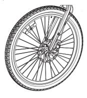
**Precaución:** nunca toque el rotor del freno, especialmente cuando la rueda y/o la bicicleta estén en movimiento, ya que podría sufrir lesiones graves. Los aceites en las manos pueden causar chirridos y disminuir el rendimiento de los frenos.
