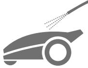
Landroid Vision a un indice d'étanchéité IPX 5 et peut être lavé avec un tuyau d'arrosage ordinaire.
