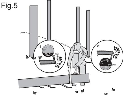
Cuando el tronco es soportado en ambos extremos, como ilustrado, corte 1/3 del diámetro de la parte superior (1). A continuación, realice el corte final rápidamente en la parte inferior (2) a 2/3 para corresponder al primer corte. (Figura 6)
