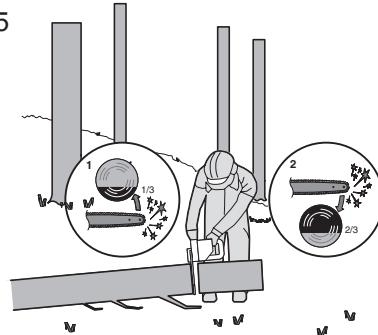
Cuando el tronco es soportado en ambos extremos, como ilustrado, corte 1/3 del diámetro de la parte superior (1). A continuación, realice el corte final rápidamente en la parte inferior (2) a 2/3 para corresponder al primer corte. (Figura 6)
