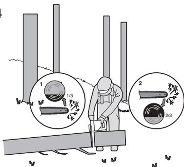
Cuando el tronco es soportado en ambos extremos, como ilustrado, corte 1/3 del diámetro de la parte superior (1). A continuación, realice el corte final rápidamente en la parte inferior (2) a 2/3 para corresponder al primer corte. (Figura. 5)
