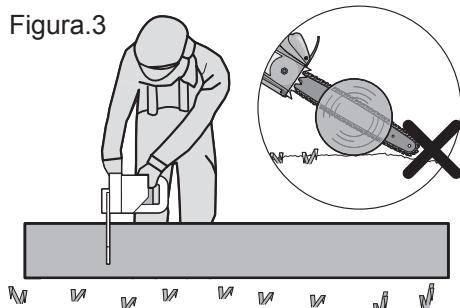
Tronco apoyado en un extremo, Haga el primer corte del lado inferior del
