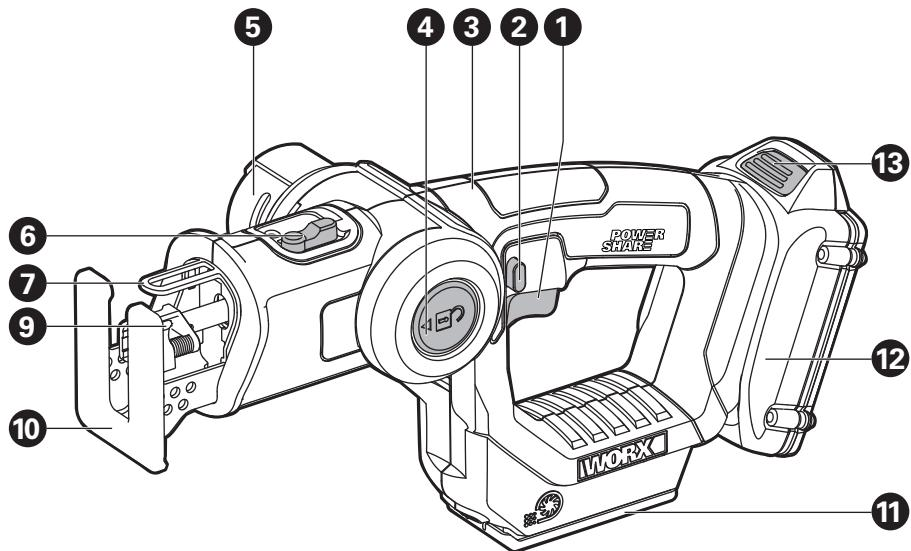
**1. ON/OFF SWITCH****2. LOCK-OFF BUTTON****3. HAND GRIP AREAS****4. PIVOT RELEASE BUTTON****5. MOTOR COVER****6. PENDULUM FUNCTION CONTROL****7. PROTECTION FINGER****8. LED WORK LIGHT (SEE FIG. H)****9. BLADE HOLDER****10. FOOT PLATE****11. BASE PLATE****12. BATTERY PACK \*****13. BATTERY PACK RELEASE BUTTON\***
